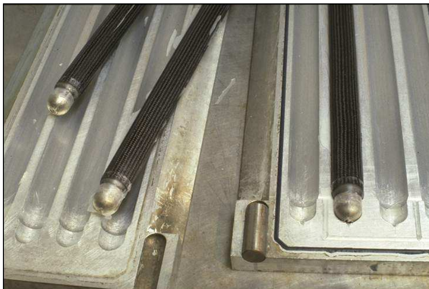
Exemple d'injection basse pression : Un cadre de vélo en carbone
